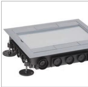
Наличие крышки напольной коробки защитит от попадания бетона при заливке. Регулировка высоты напольной коробки при монтаже может достигаться как за счет наличия регулировочных винтов (до 95 мм), так и за счет нивелирующего комплекта.
