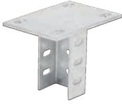
Для ортогонального подвеса кабельной трассы. Может использоваться для прокладки кабельной трассы в настенном и напольном исполнении. Толщина профиля 2 мм. Толщина основания 5 мм
